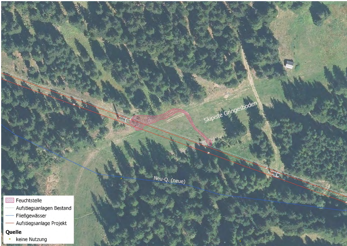
Abbildung 8: Sekundäre Feuchtstelle durch Hanganschnitt im Bereich der Querung Skipiste Gringesboden
