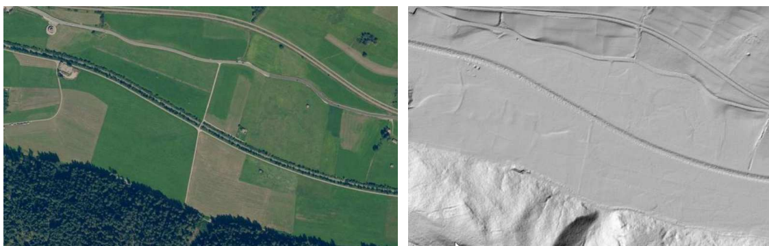
Figura 13. Ortofoto 2020 e Sfumo DTM 0,5 m per l'area del canale di restituzione in Drava e del rilevato stradale di collegamento alla SS49 nella piana del fiume Drava.
